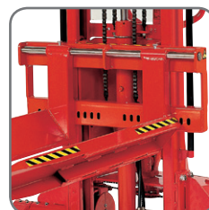
Las horquillas para bidones se montan sobre una carro portahorquillas especial para bidones.
