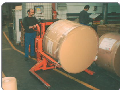
Las horquillas para bidones sólo se pueden acoplar a los modelos de Logiflex con carro de eje pasador especial para bidones.
